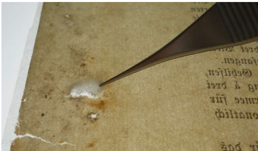
Ручна рестаурација јапанском хартијом у лабораторији Архива Војводине
