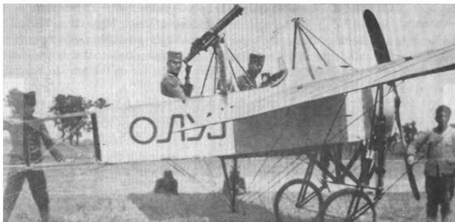
Први наоружани авион Војске Србије 1915. године. Авион је Блерио XI-2, пилот је Томић, а посматрач је Михајловић.
