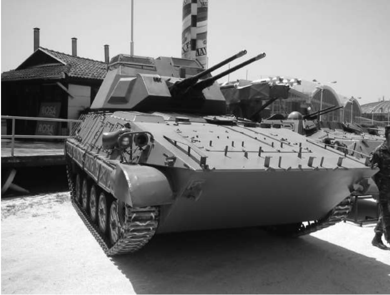
Прототип возила БВП са ПА топом 30/2 није ушао у наоружање ЈНА (снимио аутор)
