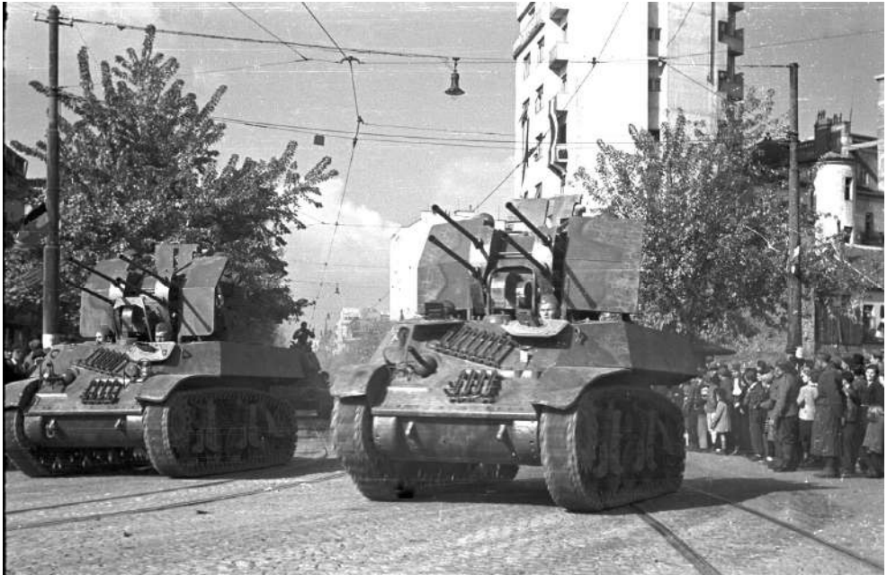
Два тенка Стјуарт, модификована у 1. тенковској бригади уградњом четвороцевног ПА топа ФЛАК М-38, 4/20 мм, на паради, Београд 20. октобар 1945. (МЦО)
