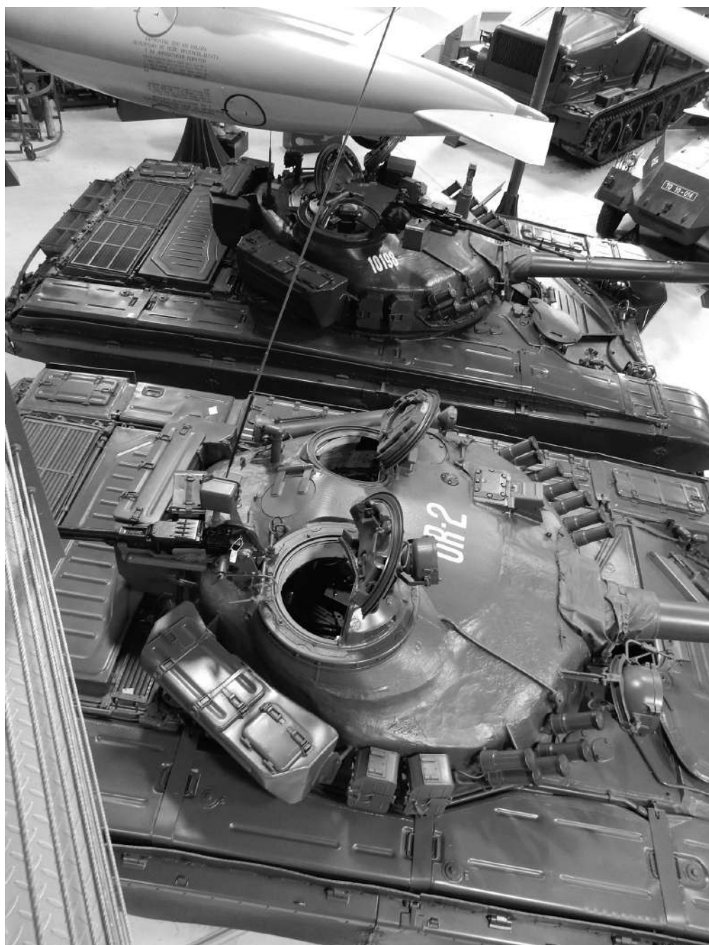
Поглед на куполу тенка Т-72 (ОР-2) и серијског тенка М-84, ради уочавања разлика на куполи. Овде у Парку војашке згодовине у Пивци (снимио аутор)
