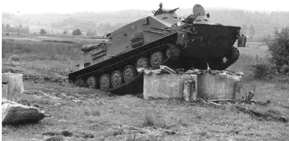
Чехословачки ОТ Топас, набављен 1965. године, у току испитивања. Извесно време се рачунало да ће овај оклопни транспортер ући у наоружање ЈНА, али га је у директном испитивању „победио“ совјетски БТР-50 (Војни архив)
