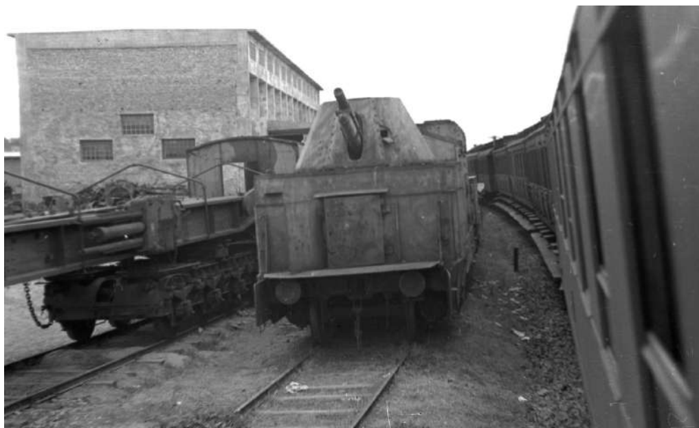
Наредни снимак композиције, такође на прузи у Централној тенковској радионици у Младеновцу, приказује два Панцејегервагона са куполама са тенкова Панцер IV верзије Ј (С. Росић)
