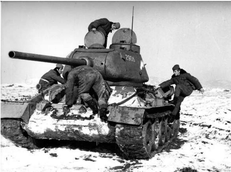
Увежбавање посаде тенка Т-34 (2906) који и даље носи белу муњу, ознаку агресорских јединица на маневру Слобода 71, током наредне зиме 1971/72 године. Уочава се да је тенк опремљен ИЦ-фаровима и МЗАЗ пумпом, што је индикатор постепеног довођења флоте тенкова Т-34 у ЈНА на стандард Т-34Б
