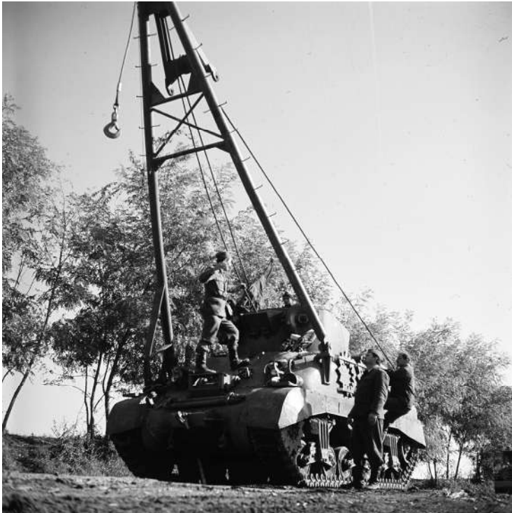
Оклопна техника добијена из америчке војне помоћи коришћена је интензивно и током прве половине 1970-их година. Горе, тенкови М-47 Патон прелазе преко понтонског моста. Доле, тенк за извлачење типа М-32 у акцији (МЦО)
