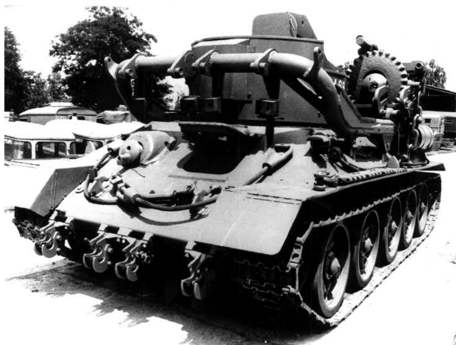
Прототип модификације тенка Т-34 (бр.--68) означене као М-67 – конверзија у специјалистичко инжењеријско возило
