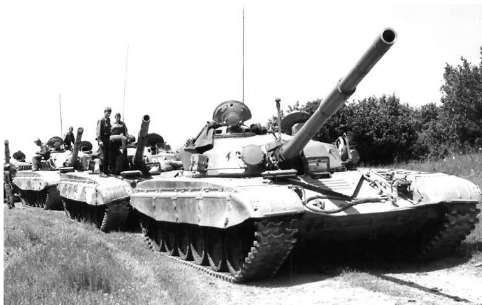
Колона првих примерака тенкова Т-72 из које ће настати југословенски М-84, током проба. Челни тенк, Т-72 са метео-сензором А20ХМБ(Л), потом Т-72 са ознаком ОР на десној страни куполе и два М-84 из прве серије са истим метео-сензором
