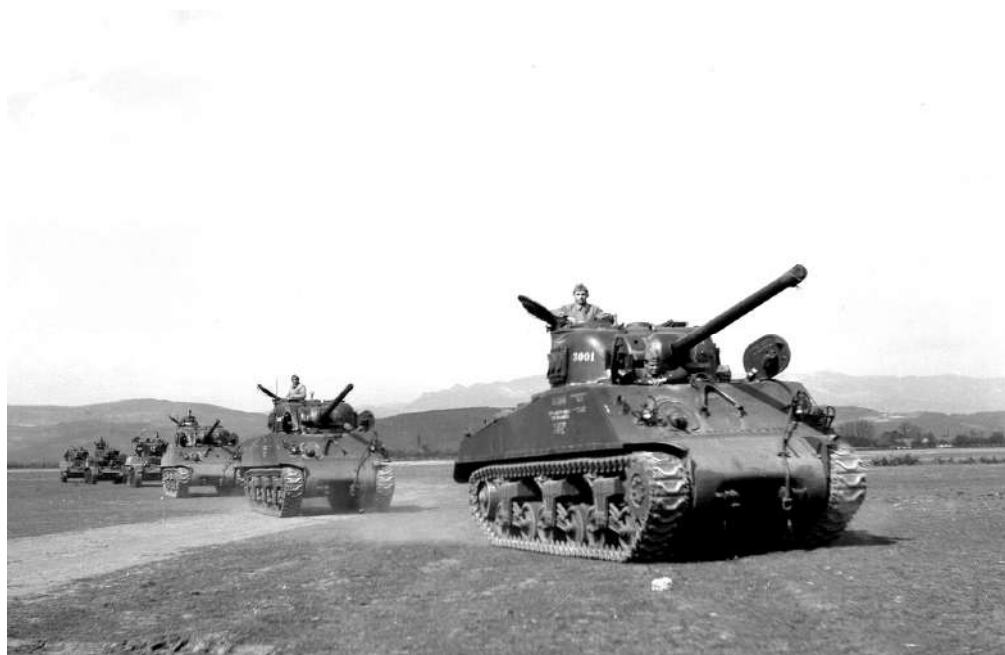
Смена генерација у оклопним јединицама ЈНА у пролеће 1952: новоиспоручени тенкови М4А3 Шерман и ратни ветерани М3А1 и М3А3 Стјуарт у вожњи, 121. тенковски батаљон, Сарајево (МЦО)
