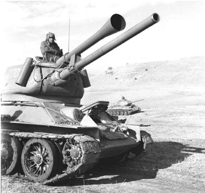
Одличан поглед на тенк Т-34 (2702) са имитатором опаљења и пушкомитраљез М-53/МГ-42, уместо формацијског тенковског митраљеза ДТ (МЦО)
