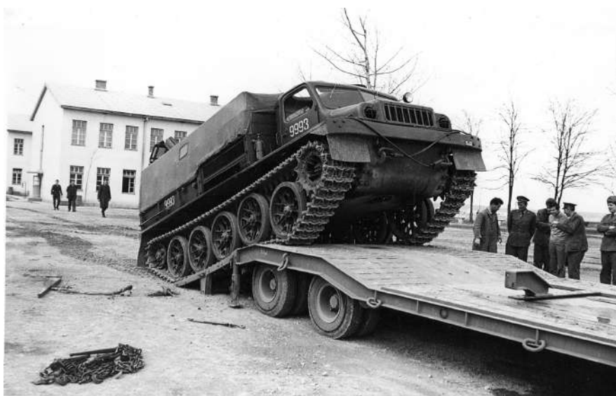
Артиљеријски трактор АТС-59Г (овде бр. 9993) израђен на бази ходног дела тенка Т-54, служио је за вучу артиљеријских оруђа највећег калибра: 155 или 203мм (Војни архив)
