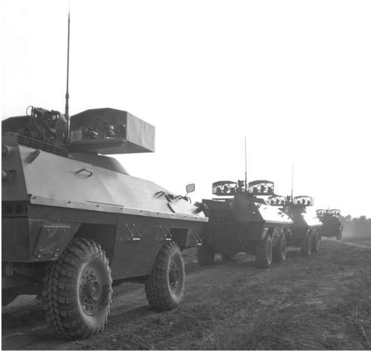
Противоклопно самоходно оруђе М-83, познато као БОВ-1, ушло је у састав противоклопних јединица ЈНА. Овде колона таквих возила на вежби Јединство 83 (МЦО)
