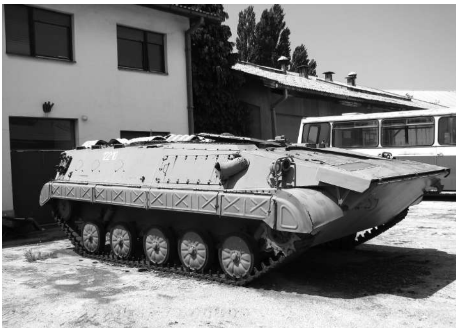
Један од БВП М-80А (12210) без надградње, снимљен у Техничком опитном центру после неке од модификација (снимио аутор)
