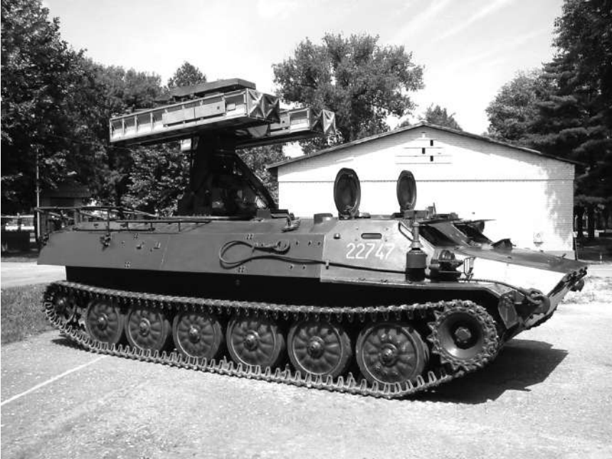
У другој половини 1980-их набављена је мања партија ракетног система Стрела 10М уграђеног на оклопни транспортер МТ-ЛБ (снимио аутор)
