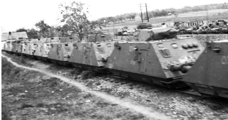
Паркирана композиција једног од оклопних возова 202, 203 или 204, састављених искључиво од оклопних моторних кола типа К-2670 Штајер. У првом плану оклопна артиљеријска моторна кола са топовском куполом 75 мм, са тенка Панцер III верзије Н, потом оклопна моторна кола са уређајем везе за командовање и иза њега моторна кола за смештај пратеће пешадије. Централна тенковска радионица у Младеновцу 1946. године (С. Росић)
