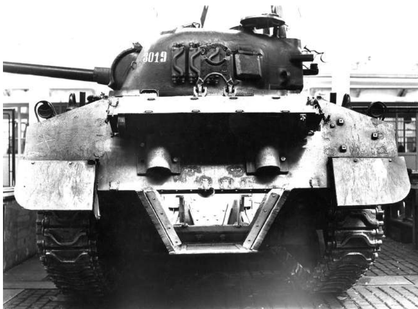
Један тенк типа М4А3 модификован је уградњом мотора В-2 са тенка Т-34 и коришћен за испитивања под називом М-634 током 1958. и 1959. године, у околини Сарајева. Модификација није прихваћена (Војни архив)
