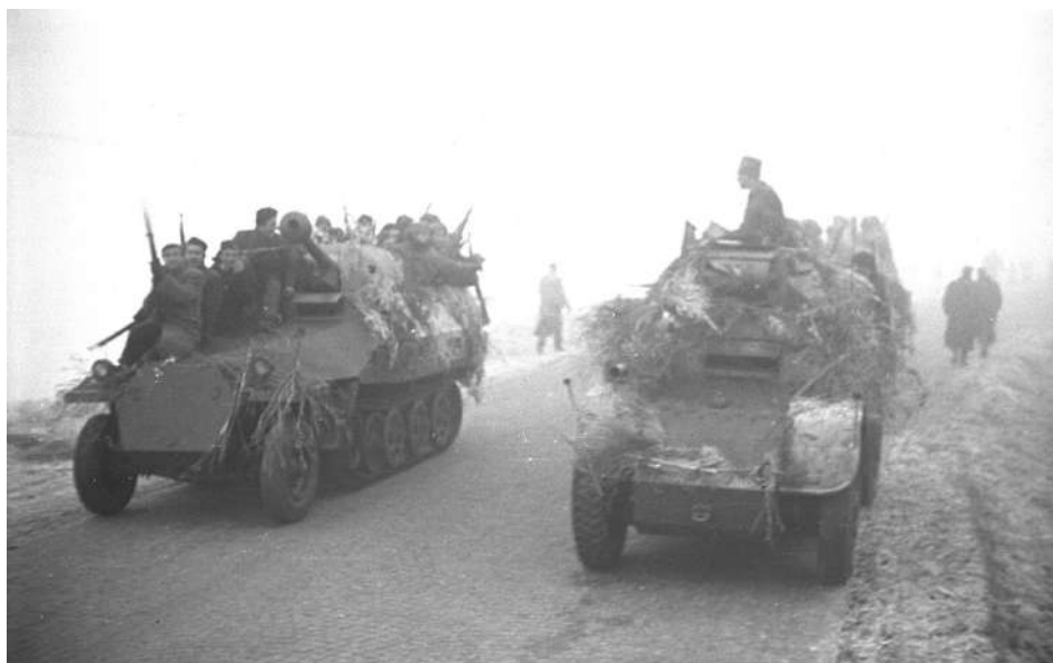
Оклопна јединица (чета) КНОЈ-а на обуци 1951. године: оклопни аутомобил АБ-41 Аутоблинда и полугусеничар Сд.Кфз 251/22 са укрцаном пешадијом – махом у цивилним оделима и само са наоружањем (МЦО)
