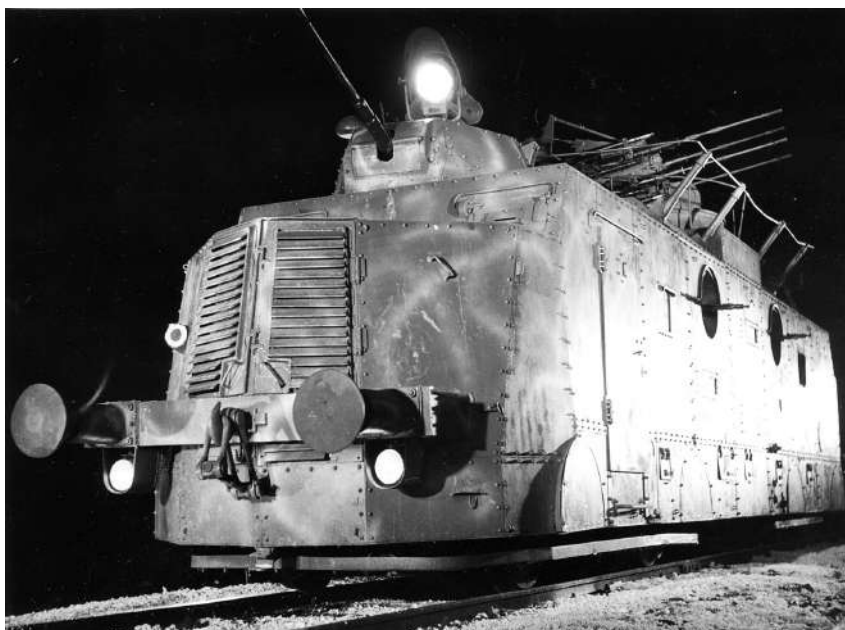
Једна од ретких илустрација употребе оклопних возова у Југословенској армији: вероватно ради снимања некаквог партизанског филма: оклопна кола италијанске производње типа Ансладо-Фосати Литорина Блиндате АЛн56, називане у ЈА „Фијат“ (кол. Александар Смиљанић)
