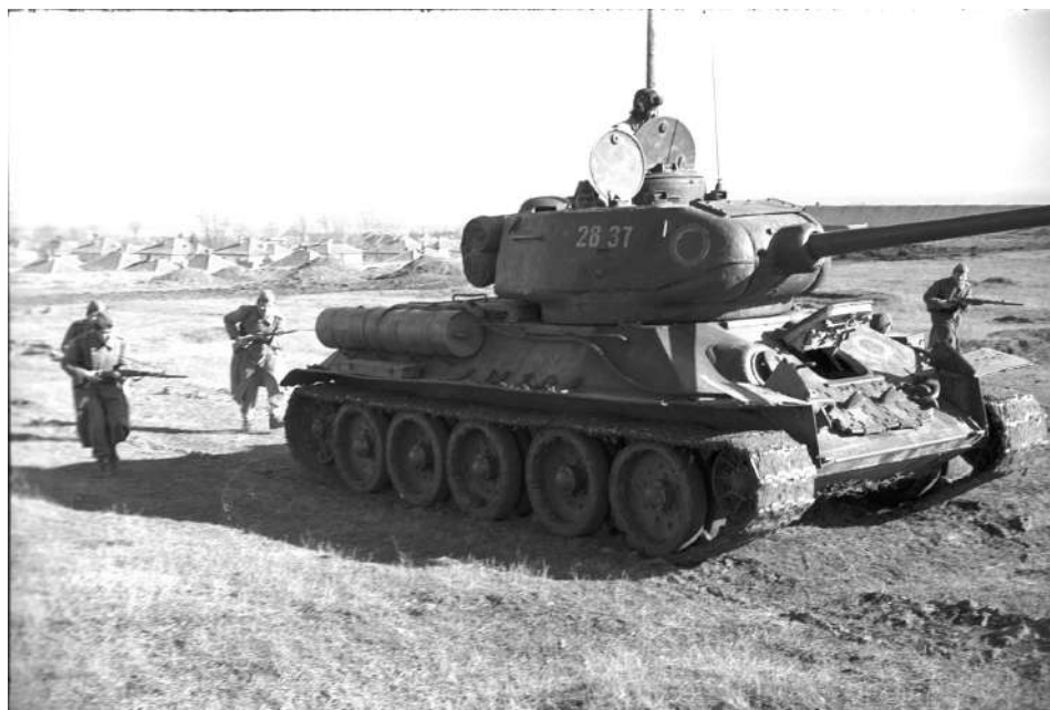
Ужежбавање садејства тенкова и пешадије у 203. оклопној бригади у Смедереву. Тенк Т-34, бр. 2837 носи кружне ознаке на челу куполе и десно од лука возача (МЦО)
