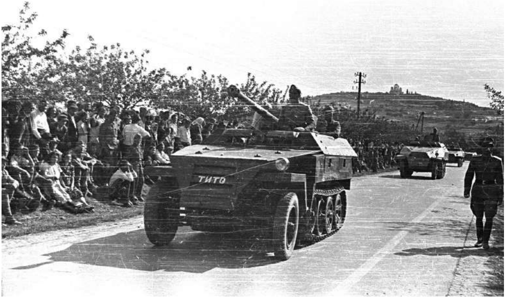
Немачки полугусеничари – у ЈА називани „Ханомаг“ по произвођачу – на дефилеу после завршетка шумадијског маневра. Колону предводи један Сд.Кфз 250 са ПТ топом, а за њим се уочавају још три полугусеничара Сд.Кфз 251 (МЦО)
