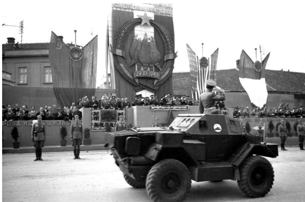
Редак примерак на југословенском ратишту: оклопни аутомобил Линкс, који је био канадска верзија британског оклопног возила Дајмлер Динго. У ЈА је служио као командно возило (МЦО)
