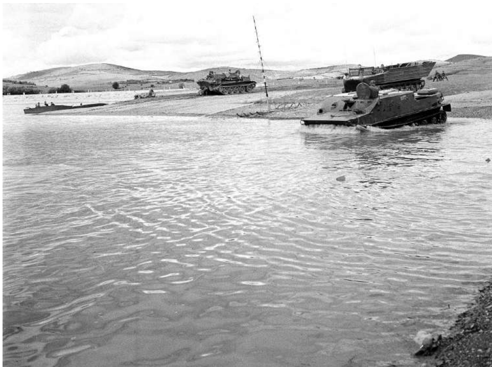
Увежбавање савладавања водених препрека, 1971: препознајемо БТР-50К (10172, из 329. окбр) и амфибију К-61 пред улазак у воду. Са стране, за сваки случај, постављен је један тенк за извлачење (ХДА)
