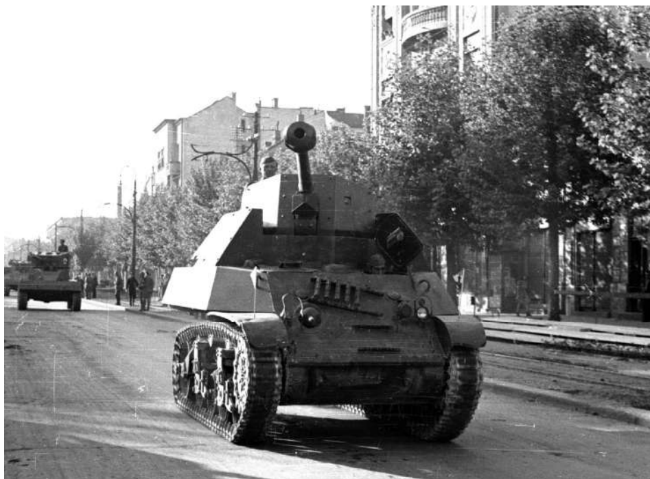
Стјуарт, модификован у 1. тенковској бригади уградњом ПА топа Флак, на паради, Београд 1946. У позадини, тенк Стјуарт са уграђеним противтенковским топом (МЦО)
