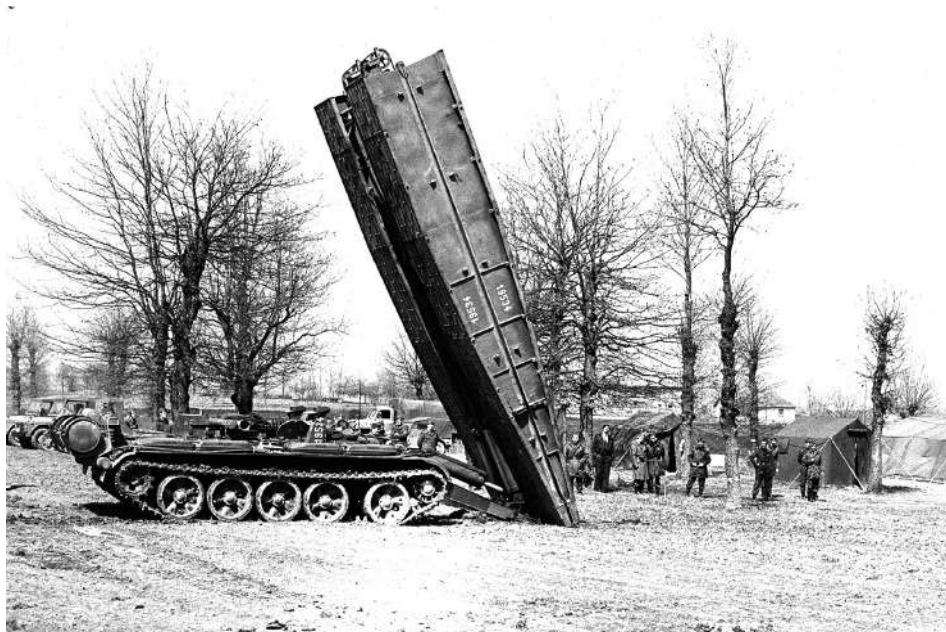
Горе: проба постављања лансираног моста на тенку МТ-55 (ч) у 211. оклопној бригади крајем 1970-их (211. окбр). Доле: исти тенк без моста, у истој јединици, три деценије касније (снимио аутор)
