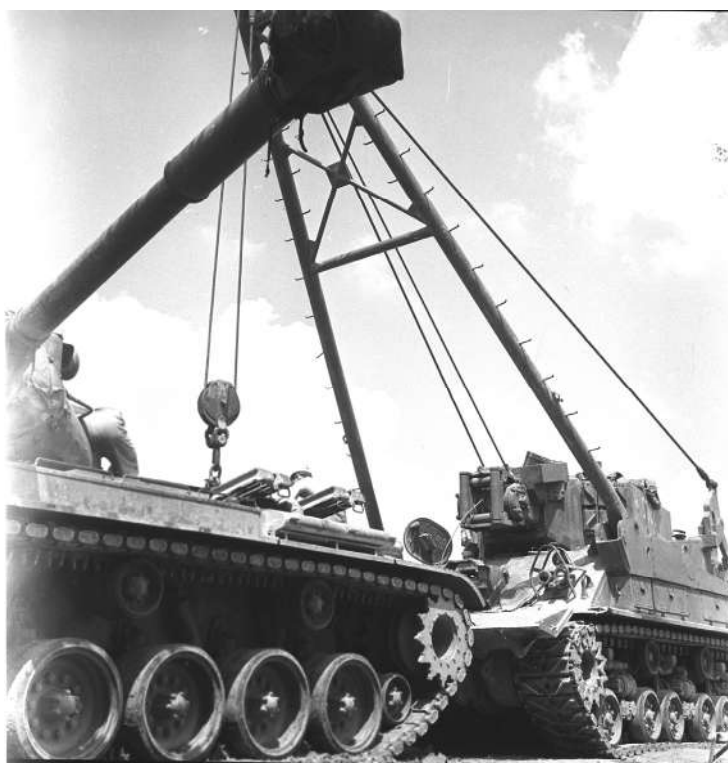
Тенкови за извлачење М-74 били су додељени јединицама наоружаним тенковима М-47 Патон. На фотографијама: вађење мотора типа Континал из тенка М-47 (МЦО)
