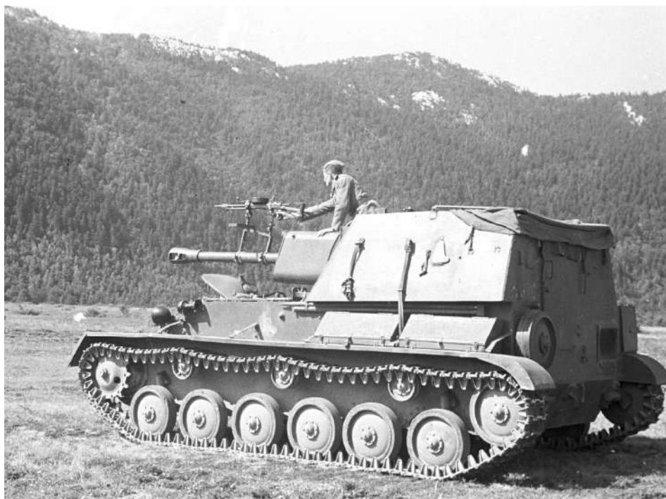
Совјетске самоходке СУ-76 ушле су у састав противоклопних самоходних јединица КТМЈ. Овде на положају у Словенији, 1949. године са спрегнутим митраљезом ДТ за бојево гађање (МЦО)
