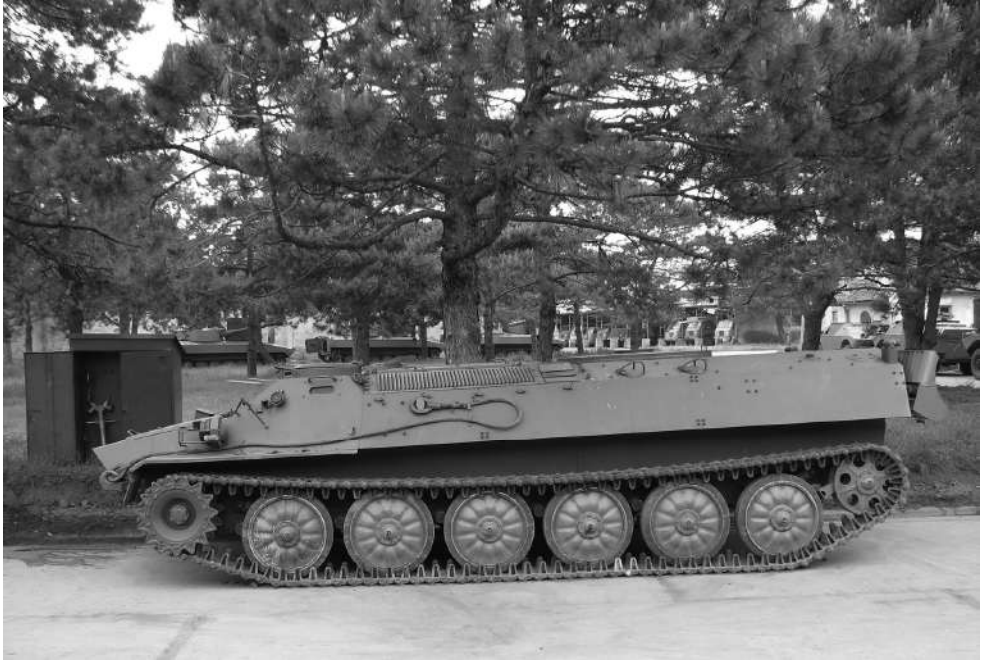
Један транспортер МТ-ЛБ без икакве надоградње или са скинутим системом С-10М, коришћен је касније за обуку – овде у центру у Пожаревцу. Доле, један БВП такође без система Стрела 10 снимљен у Техничком опитном центру (снимио аутор)
