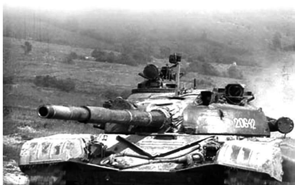
Други тенк (20642) из исте серије са уграђеним метео-сензором А20ХМБ(Л), какав је касније уграђен на првој серији тенкова М-84
