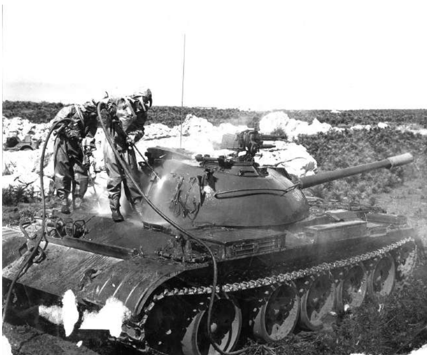
Увођење тенкова Т-54 и Т-55 у наоружање омогућило је планирање употребе ОМЈ у условима нуклеарног рата. На фотографији: деконтаминација тенка 9474 из састава 31. оклопне бригаде (КА)
