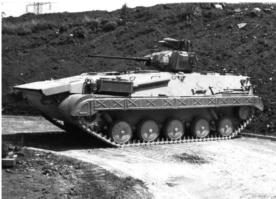
БВП М-80А1 са куполом Видра. Уочљива је разлика у односу на стандардну куполу. Овде на полигону фабрике ФАМОС током испитивања
