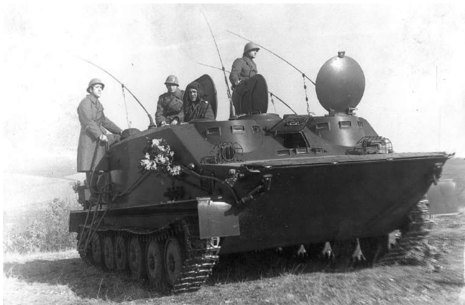
Оклопни транспортер БТР-50ПУ, командно возило оклопних али и других пешадијских, моторизованих и механизованих бригада. Разликује се по две туреле на чеоној страни и повећаном броју радио-уређаја. Овде, тек испоручено возило из састава 211. оклопне бригаде (211. окбр)
