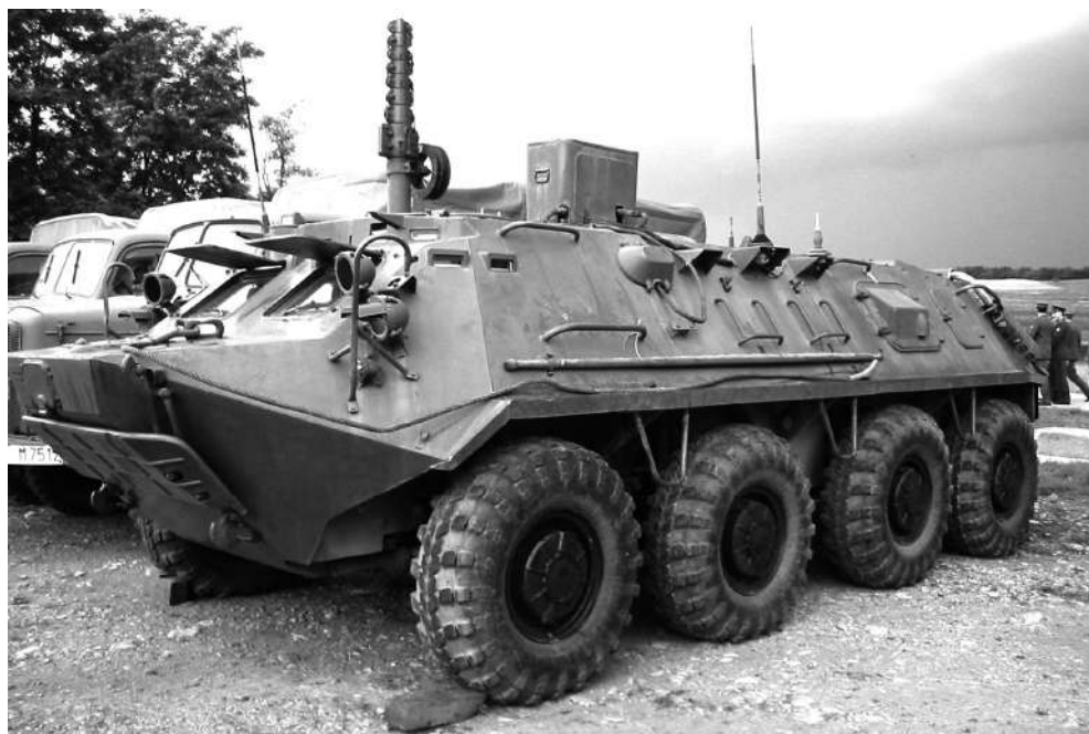
Са ракетним системима Стрела 1М и Куб испоручена су и командна возила БТР-60ПУ-12, израђена на бази основне верзије овог типа оклопног транспортера (снимио аутор)
