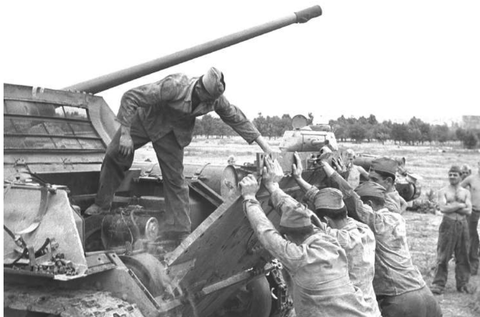
Рад на мотору В-2 на тенку Т-34, у теренским условима, често је захтевао доста физичке снаге и труда. Овде, војници тенкисти 4. гардијског оклопног батаљона, дижу или спуштају поклопац мотора (МЦО)
