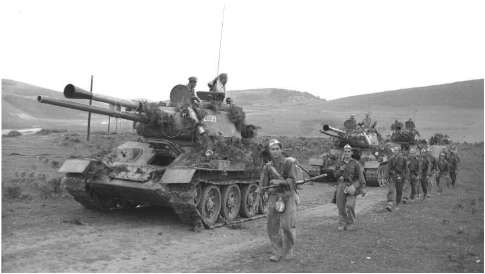
Тенкови Т-34 5. оклопног пука и пешадија са белим вежбовним ознакама на капама у садејству, почетком 1960-их. Сва три тенка имају монтиране имитаторе опаљења. Први тенк у колони (2839) има на позицији митраљесца пушкомитраљез М-53/МГ-42, уместо формацијског тенковског митраљеза ДТ (МЦО)
