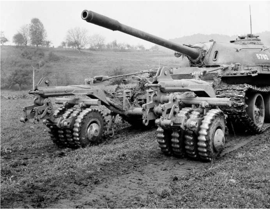
Тенк Т-55 (6702) из 1. оклопне бригаде са уређајем за разминирање, маневар Слобода 71 (ХДА)
