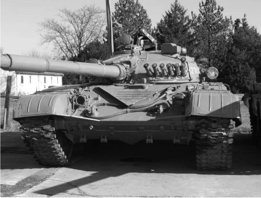
Чеоно изглед тенка М-84 прве серије (21092), са препознатљивим детаљима: преклопним метео-сензором А20ХМБ(Ј) (снимио аутор)
