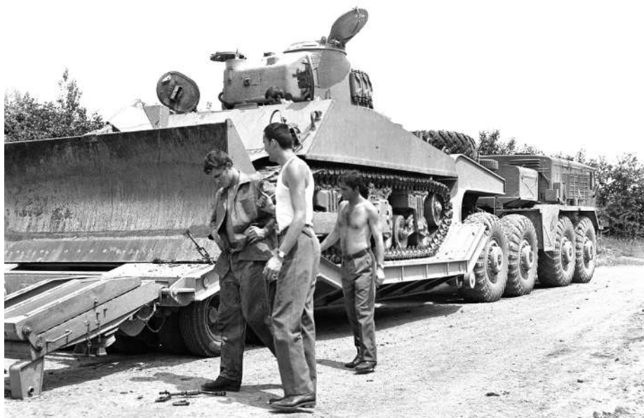
Укрцавање тенка Шерман са булдожером на вучни воз М-69, састављен од совјетског тегљача МАЗ-537Г и домаће приколице типа Горица, 5. армија, 1972 (ХДА)
