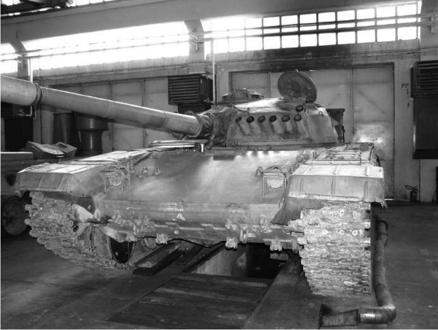
Тело тенка „Вихор“ са куполом обичног М-84 сведочи о достигнутом степену развоја овог тенка до почетка рата 1991. године (снимио аутор)
