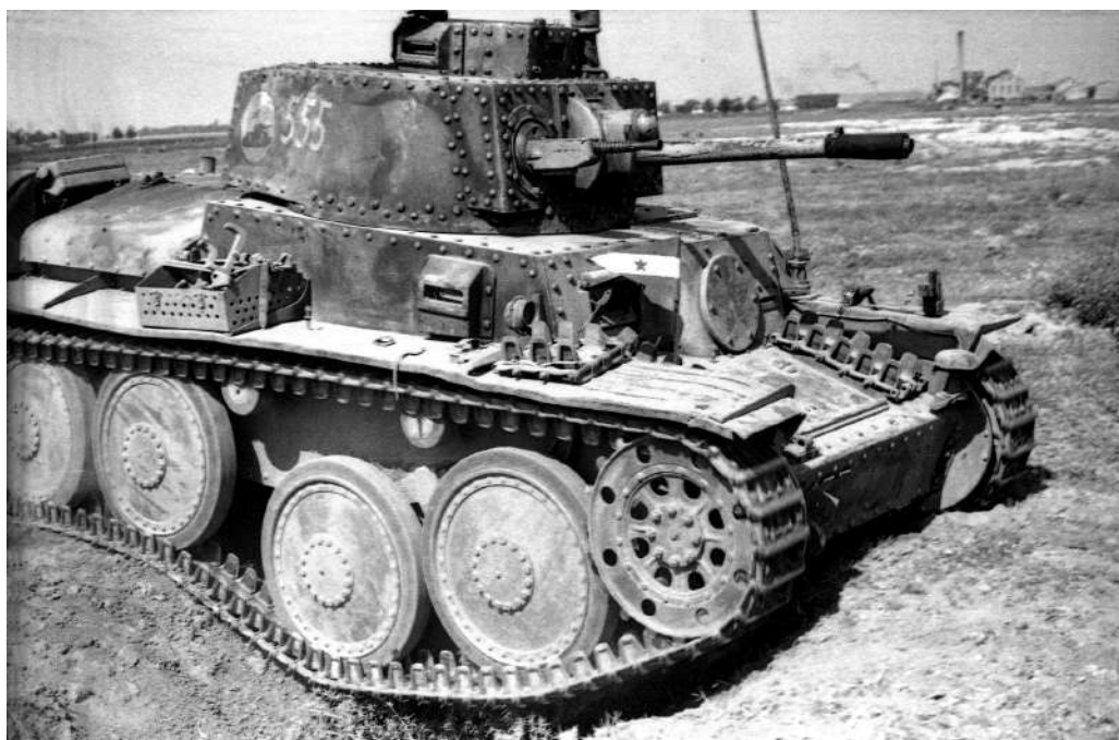
У саставу 4. тенковске бригаде трофејна техника се налазила до почетка 1950-их. На фотографији: камуфлажно обојени тенк типа Пз.Кпфв.38 (т) верзије Б или једноставно „Прага“, са бројем 555 и знаком КТМЈ (МЦО)
