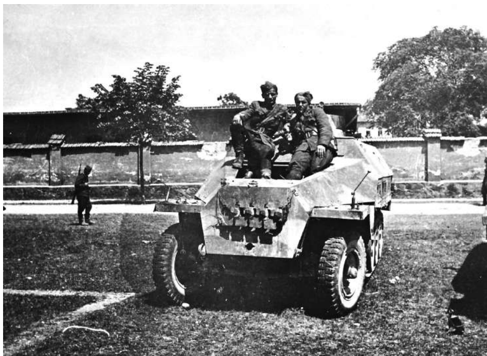
Заплењени немачки полугусеничар Сд. Кфз. 251/17 са ПА топом калибра 20 мм (Музеј револуције народа БиХ у Сарајеву)
