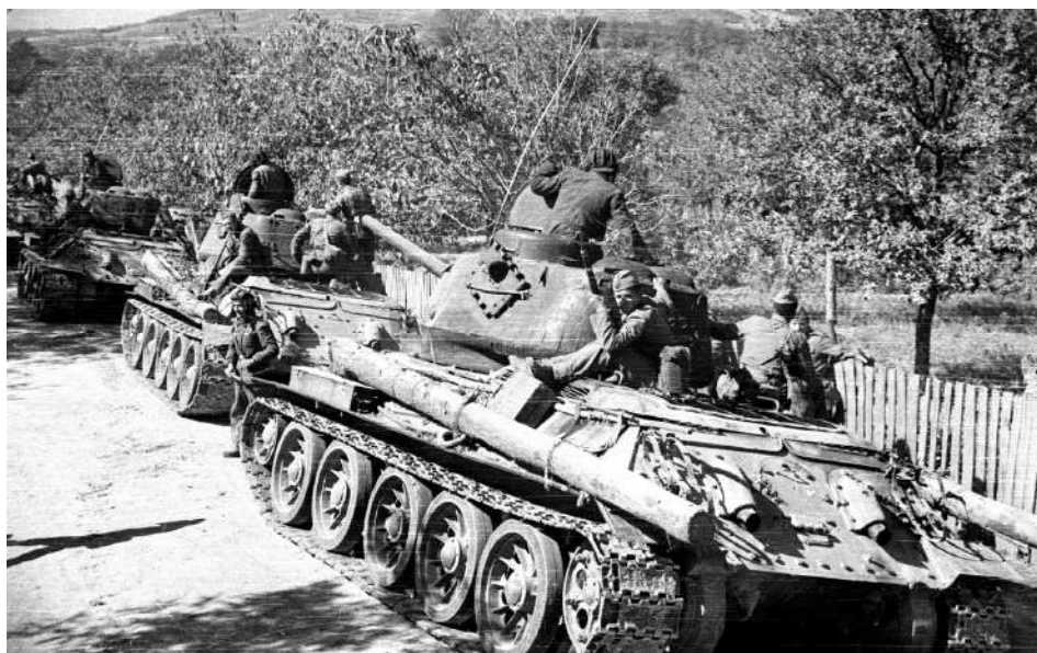
Тенкови Т-34 са тенковским десантом током великог јесењег маневра у Шумадији 1949. године. Балвани на странама тенкова служе за извлачење из блата (МЦО)
