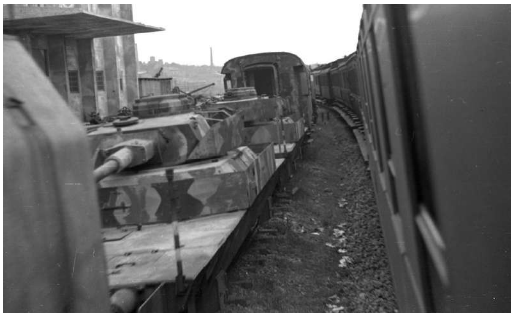
Заплењен немачки оклопни воз на прузи у Централној тенковској радионици у Младеновцу 1946. године. У првом плану оклопни вагон са хаубицом 100 мм. Лево се уочава вагон од железничког топа С калибра 280 мм (кол. Слободан Росић)
