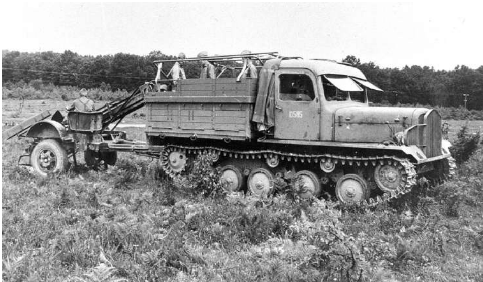
Трактор Фап ГЈ-800 израђен по лиценци мађарског трактора Чепел К-800. Овде бр 0585, вуче минополагач ПМР-3. Ходни део трактора коришћен је за израду оклопног транспортера. У оба случаја реч је о ходном делу совјетског предратног тенка Т-70 односно самоходке СУ-76
