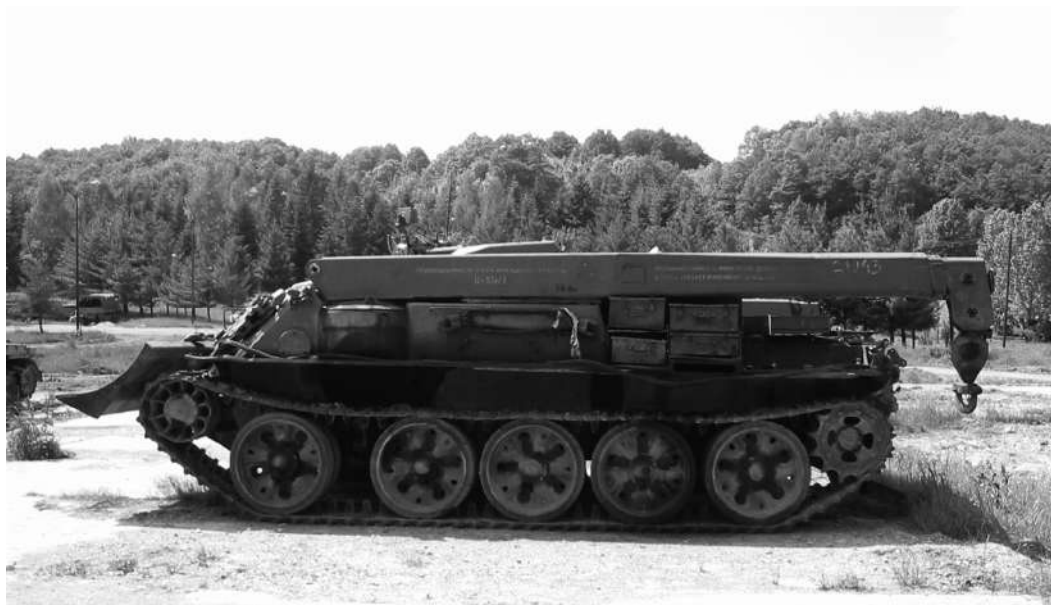
Модернија верзија тенка за извлачење ВЗТ-2 уведена током 1980-их Овде тенк бр. 21043, на полигону Пасуљанске ливаде (снимио аутор)
