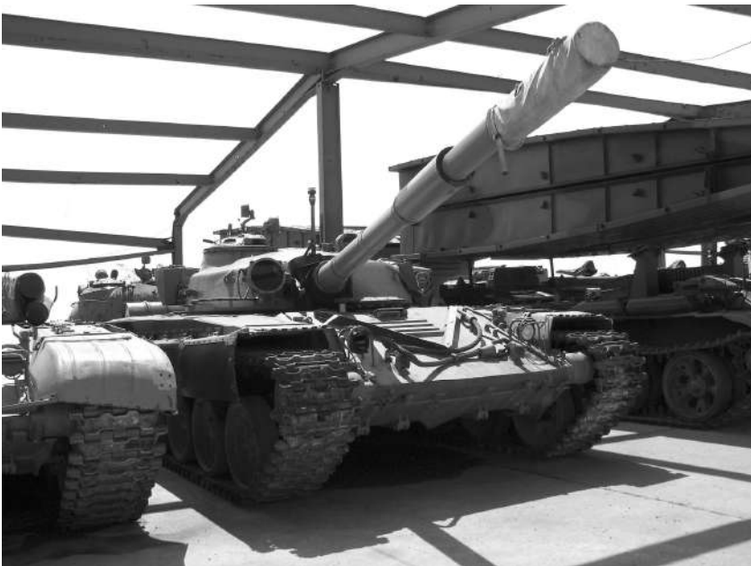
Трећи примерак тенка Т-72 произведен по лиценци у Југославији означен је као Т-72МЈ. Тенк је касније служио само за обуку војника техничке службе (снимио аутор)
