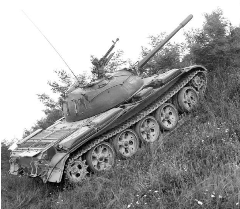
Типски снимак тенка Т-54Б (6977). Карактеристични детаљи за разликовање од Т-55 су вентилатор на десној страни куполе и ПА митраљез, које су касније добили и тенкови Т-55 (МЦО)
