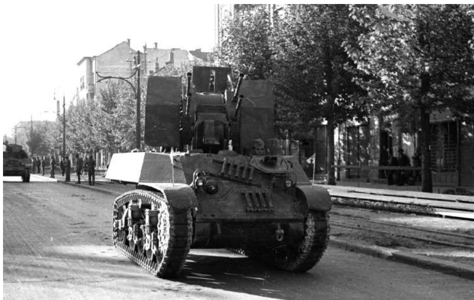
Стјуарт из састава 1. тенковске бригаде, са уграђеним противтенковски топом типа ПАК 75 мм уместо куполе, на паради у Београду, 1946. године. У позадини се уочавају оклопни аутомобили типа АЕЦ (МЦО)
